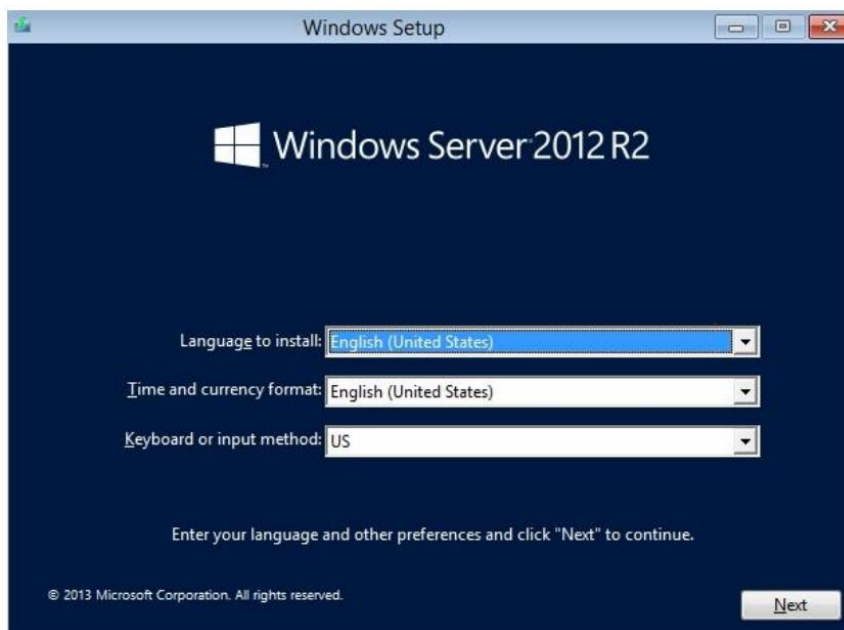
ภาพที่ 4-9 แสดงตัวเลือกเบื้องต้นในการติดตั้ง Windows Server 2012 R2
