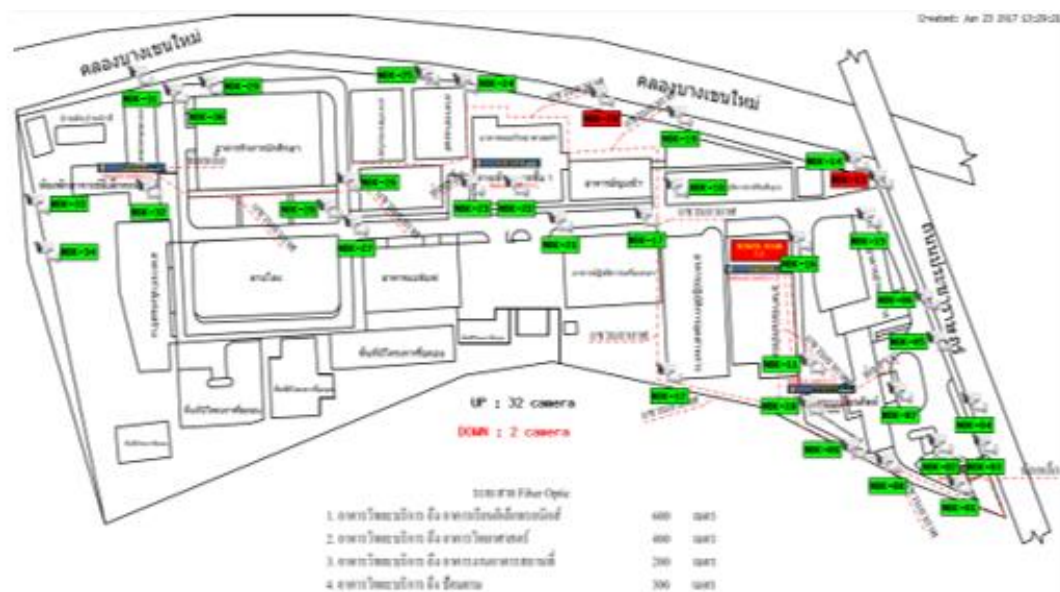
ภาพที่ 10 แผนผังแสดงระบบกล้องวงจรปิดศูนย์พระนครเหนือ
